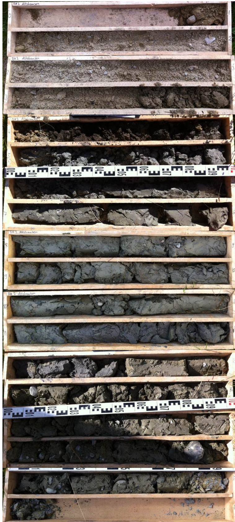
Bild 9: Bohrkern BK 1 (0,00-17,20 m)
