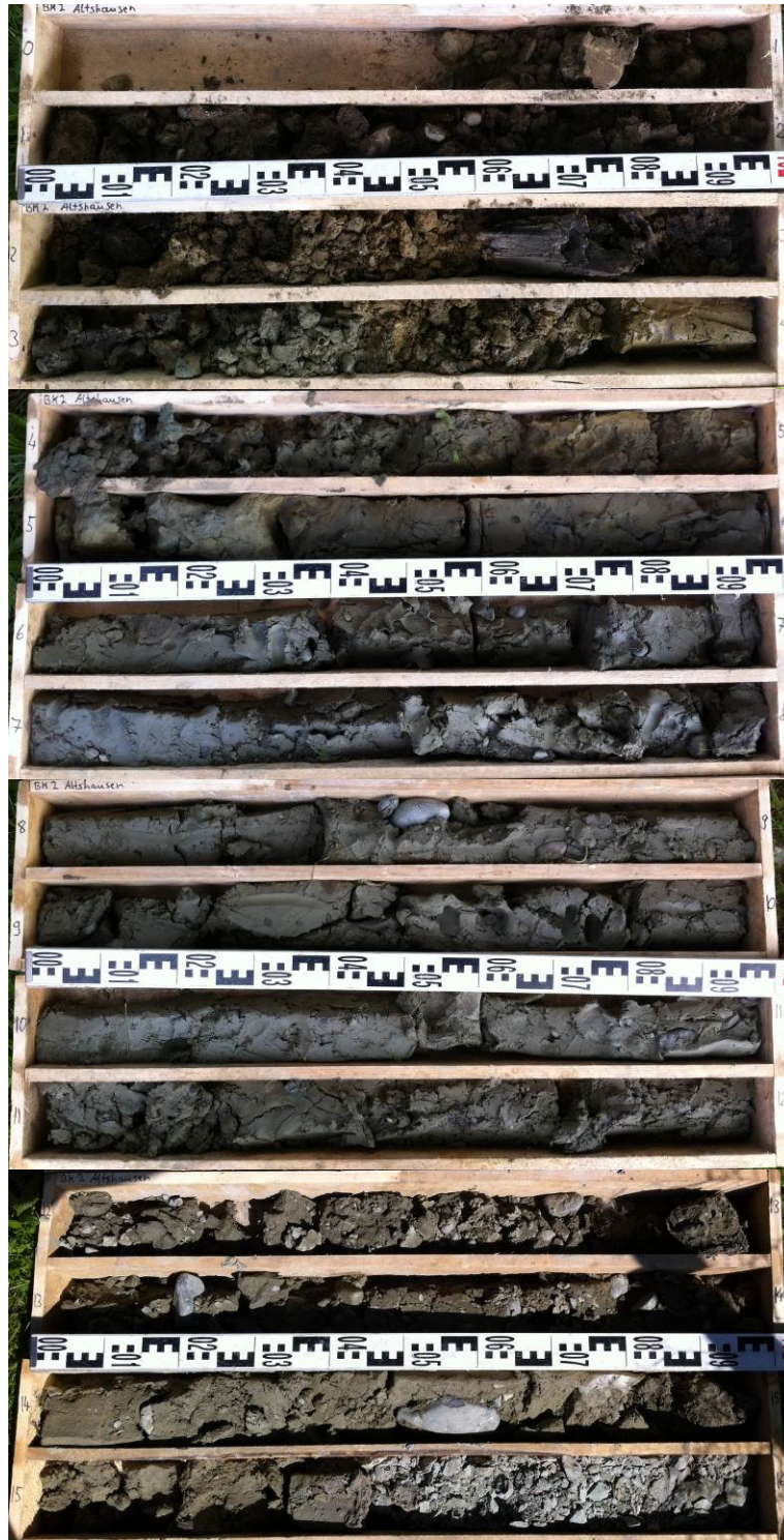
Bild 10: Bohrkern BK 2 (0,00-16,00 m)
